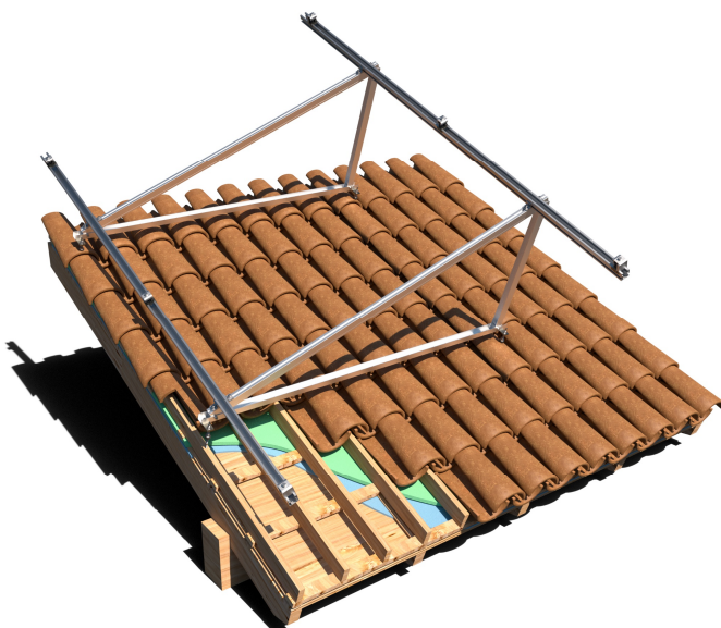
Beispiel 2: Dach mit gebogenem Dachziegel mit Unterkonstruktion aus Holz / Befestigung mit Doppelgewindeschraube KFS-MA
