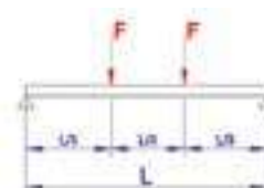
Duas cargas pontuais em L/3
